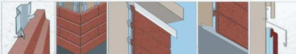
Sumontuotų plytelių užtvirtinimas
